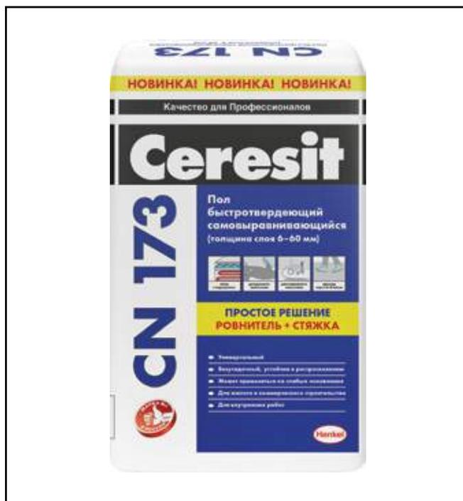
степенно добавляют в воду при перемешивании, добиваясь получения однородной массы без комков. Перемешивание производят миксером или дрелью с насадкой при скорости вращения 400–800 об/мин. Смесь должна быть израсходована в течение 30 минут с момента приготовления.
